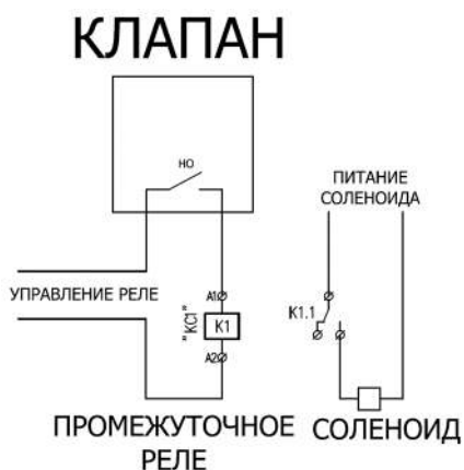
Рис.4 Схема подключения при подаче воды на СОО
