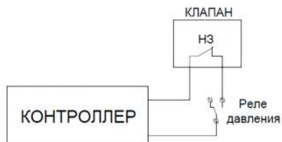
Рис.2 Схема подключения клапана в разрыв сухого хода
