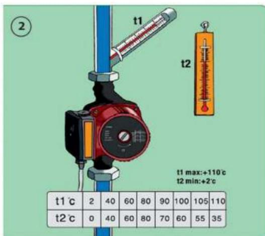
При монтаже насоса на него не должно передаваться напряжение от трубопроводов, вал насоса должен быть расположен строго по горизонтали.
