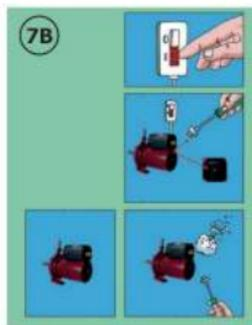
Подать напряжение и установить переключатель в положение «Мах», выкрутить винт для удаления воздуха, защитив электрические части от попадания жидкости или пара. После того, как вода, выходящая из насоса, перестанет содержать воздух, винт завернуть.
