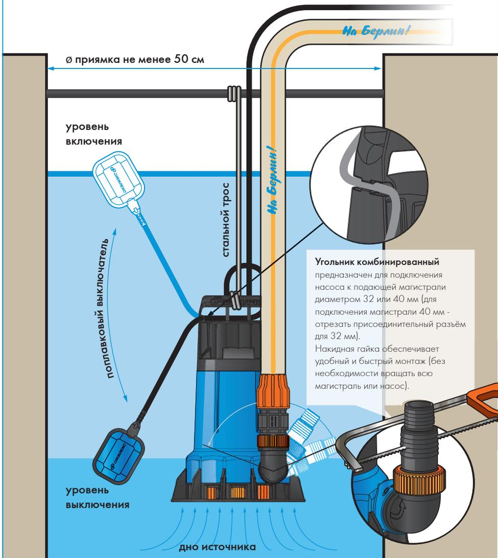
Рисунок 4 (на примере изображен насос погружной 350/17).
