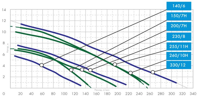
\* Заявленные характеристики насосов были получены при испытании с холодной чистой водой без газа и абразивных примесей, а также напорной магистралью диаметром 40 мм и напряжением 220 вольт.
