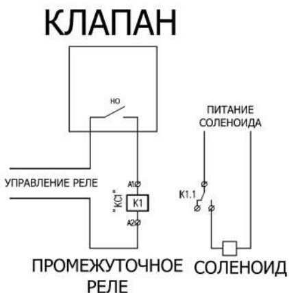
Рис.4 Схема подключения при подаче воды на СОО
