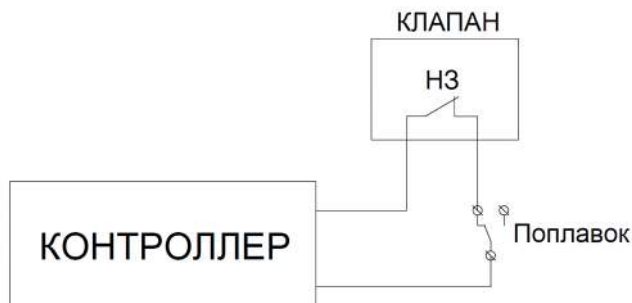
Рис.1 Схема подключения в разрыв поплавка
