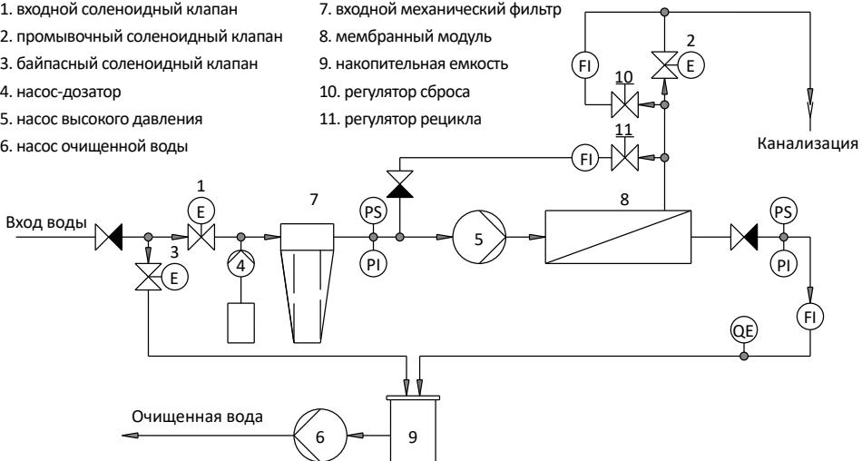
Рисунок 1. Система обратного осмоса с подмесом исходной воды
