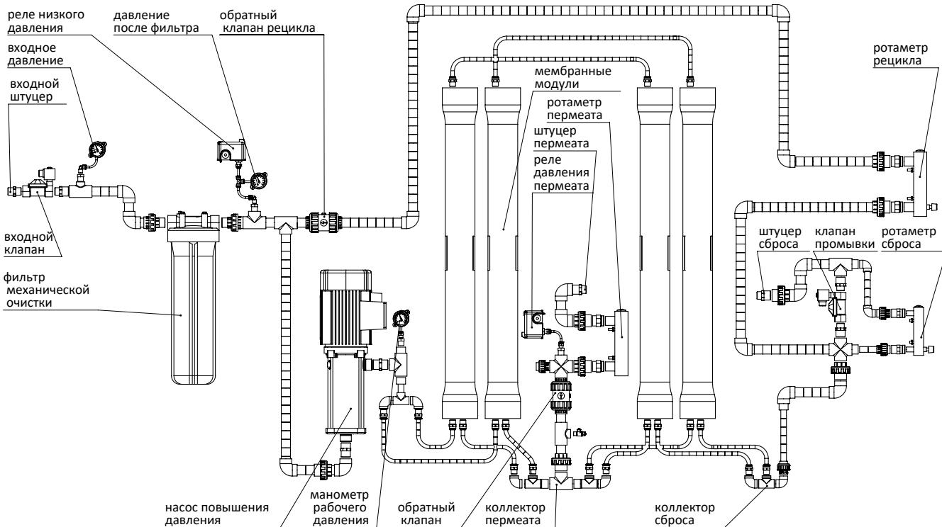
Рисунок 3. Схема системы обратного осмоса Ecosoft MO-24000
