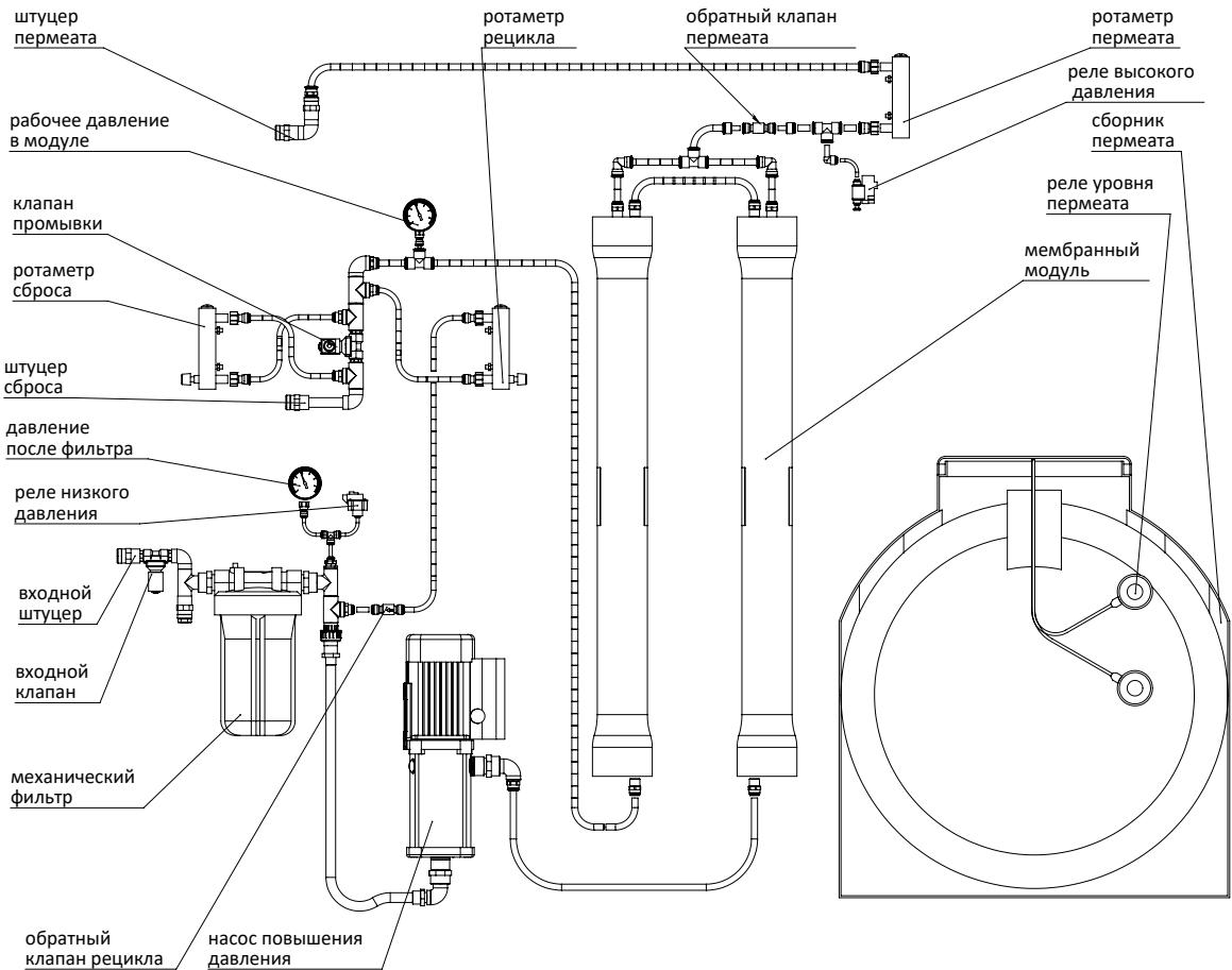
Рисунок 2. Схема системы обратного осмоса Ecosoft MO-12000
