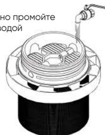
4. Смажьте прокладку основания фильтрующего элемента глицерином. Вставьте фильтрующий элемент, осторожно надавливая на него
