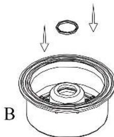
3. Вставьте часть В в часть А, и установите стопорное кольцо согласно схеме. Для удобства используйте обратные плоскогубцы
