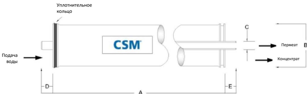
1. Каждый мембранный элемент поставляется в комплекте с одним уплотнительным кольцом, одним пермеатным адаптером и четырьмя прокладками типа O-ring.
