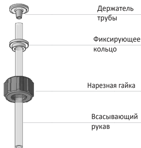
Рис. 6 Монтаж всасывающего рукава
