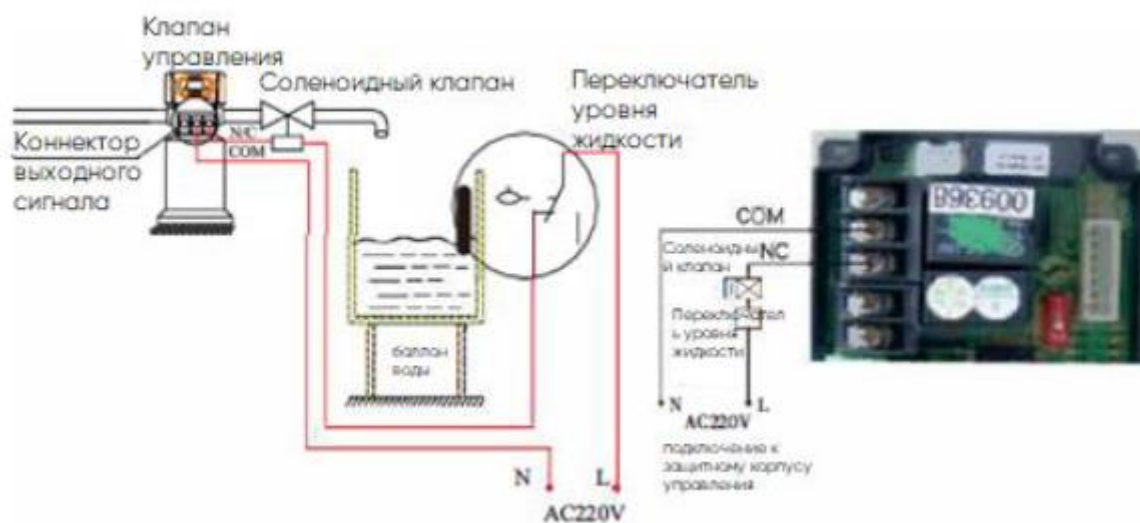
Рисунок 3-2 Подключение выпускного электромагнитного клапана
