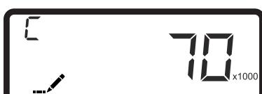
Данный параметр активен только если запрограммирована регенерация с учетом обработанной воды.
