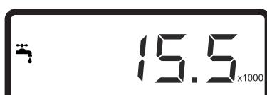
Клапан в рабочем режиме, показывает объем, оставшийся до следующей регенерации.
