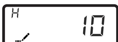
Установите жесткость исходной воды с помощью кнопок «Вверх» или «Вниз».
