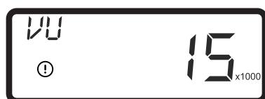
Индикация объема с момента предыдущей регенерации (л или галл. в зависимости от запрограммированного формата индикации).
