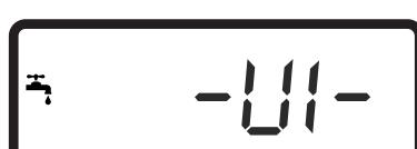
Клапан в рабочем режиме, показывает какой корпус находится в рабочем режиме.
