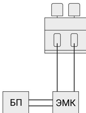
**Схема подключения электромагнитного клапана для контроллера СТ**
