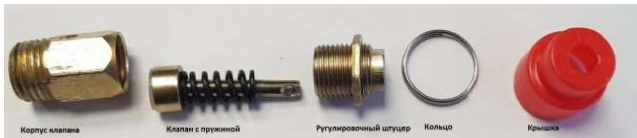
Для регулировки сбрасывающего вентиля необходимо снять стопорное кольцо, убрать красную защитную крышку, ослабить контргайку регулировочного штуцера и вращая штуцер по часовой стрелке (увеличение) или против часовой стрелки (уменьшение) установить необходимое давление сбрасывания.
