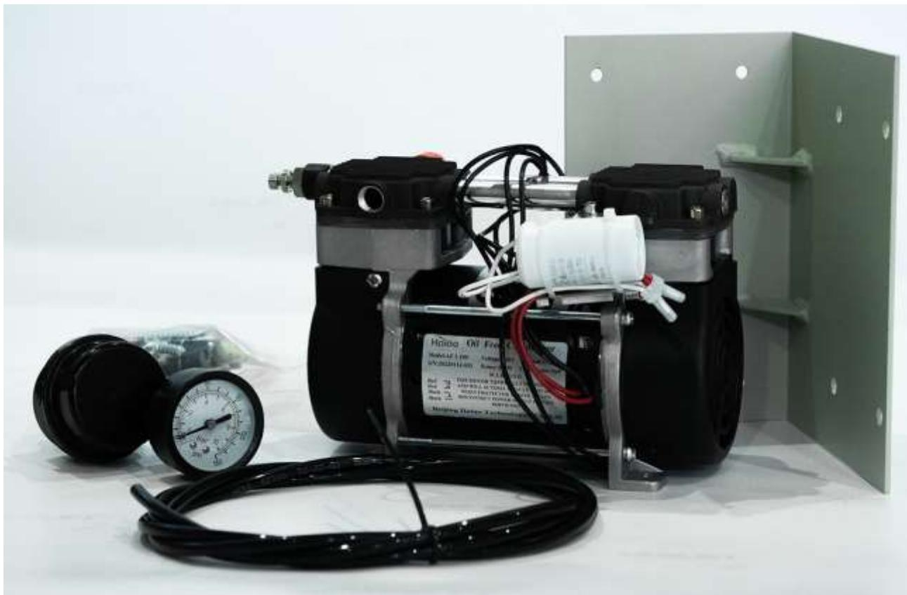
Компрессор монтируется на кронштейне, закрепляемом на стене или раме. Для снижения уровня шума и вибраций используются резиновые вибровставки (входят в комплектацию). Вибровставки одним концом вкручиваются в нижние опоры компрессора, а вторым вставляются в отверстия кронштейна и фиксируются при помощи шайбы, гровера и гайки (входят в комплект).
