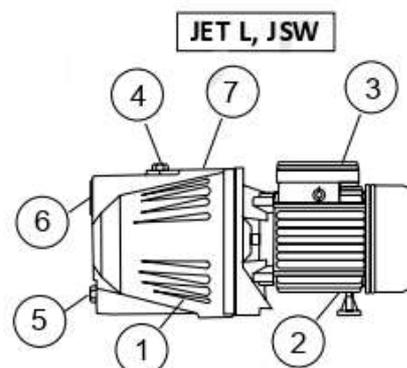
и пускового устройства – (3). Насос имеет заливное – (4) и сливное – (5) отверстия, входное – (6) и выходное – (7) отверстия.
