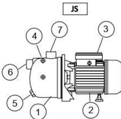
При работе насос с помощью вращающегося рабочего колеса и внутреннего эжектора всасывает воду из источника и нагнетает ее под давлением в напорную магистраль.
