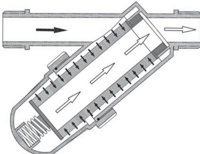
сечения. При сжатии пакета дисков эти желобки меняют форму, их поперечные сечения уменьшаются. В итоге образуется сложная объемная тонкосетчатая структура, задерживающая твердые частицы.
