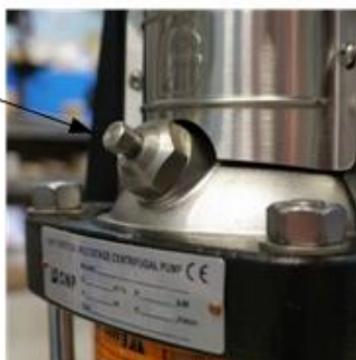
Рис.7 Пробка на насосе для выпуска воздуха.
