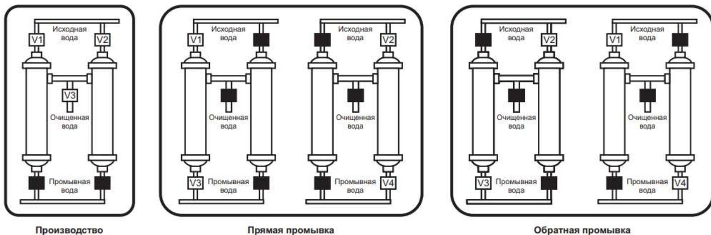
Периодически проводится промывка химическими реагентами, с целью удаления отложений, невымываемых в процессе прямых и обратных промывок. Выбор реагентов и частота промывок зависит от характера загрязнений и качества подаваемой на очистку воды.
