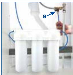
13. Удалив стопорную клипсу, вставьте трубку (а) в узел подключения до упора. Установите клипсу на место. Для разметки отверстий крепления водоочистителя можно воспользоваться трафаретом отверстий на клапане коробки
