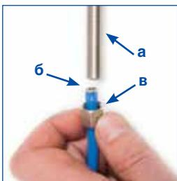
9. Подсоедините к крану (а) конец трубки с запрессованной латунной втулкой (б) и закрепите накидной гайкой (в)
